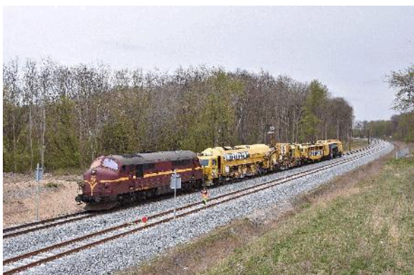
I Oh holdt CFL cargo med en svellestopper og ballastfordeler BDS 2000-4 D-SWIE 99 80 9125 002-2 + svellestopper Unimat 09-32/4A dynamic A-SWIE 99 81 9123 002-3.
